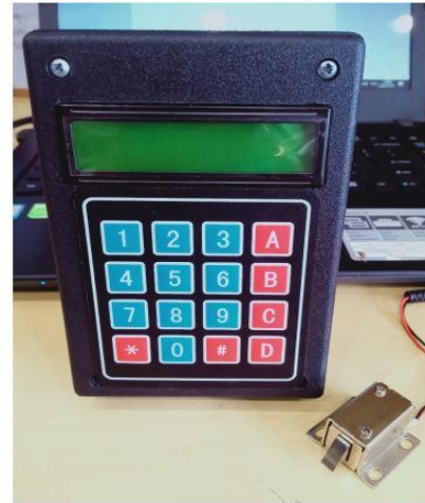
Gambar 6. Keypad Pada Box dan Solenoid Door Lock
